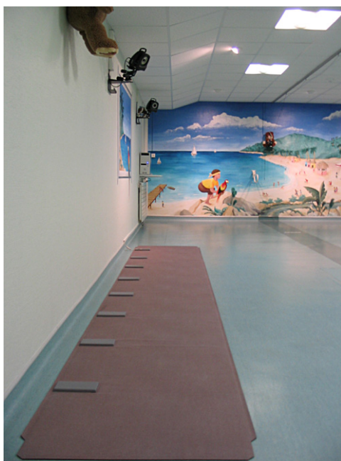
Figure 2. Piste de marche électronique GaitRite. Cette piste souple composée de plusieurs milliers de capteurs enregistre les pressions au cours de la marche.
